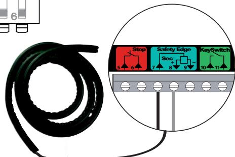
**⚠ Si une barre palpeuse filaire remplace une barre palpeuse radio, l'émetteur barre palpeuse radio doit être effacé (voir partie 12) afin que la barre palpeuse filaire soit prise en compte.**
