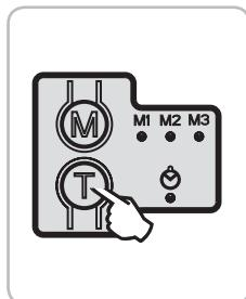
Druk kort op de toets T om een optie voor het automatisch sluiten te activeren.
