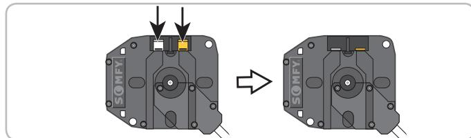
Nota : i finecorsa del motore possono anche essere regolati con un cavo di regolazione (cod. 9015971). In questo caso, regolare i finecorsa con il cavo, poi passare alla fase [8] per uscire dalla modalità di regolazione del motore.
