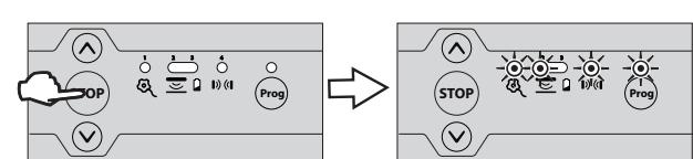
Quando la modalità vacanze è attivata, ogni pressione esercitata su un comando bloccato (interfaccia di programmazione o trasmettitore) provoca un lampeggiamento dei LED 1, 2, 4 e Prog per 2 secondi.
