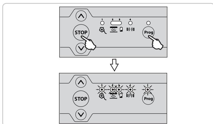
Zur Entsperrung der Programmiertasten wiederholen Sie den oben beschriebenen Vorgang.
