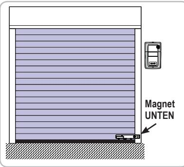
Bei Nutzung einer ohmschen Sicherheitsleiste ist die Installation eines unteren Abschaltmagneten vorgeschrieben.
