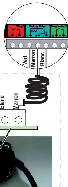
**⚠ Si une barre palpeuse filaire remplace une barre palpeuse radio, l'émetteur barre palpeuse radio doit être effacé (voir partie 12) afin que la barre palpeuse filaire soit prise en compte.**
