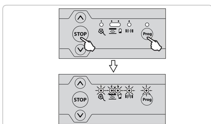
Per sbloccare i tasti di programmazione, ripetere la procedura di bloccaggio sopra descritta.
