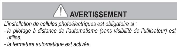
**⚠ Si suppression des cellules, il est impératif de faire le pont entre les bornes 18 et 19.**
