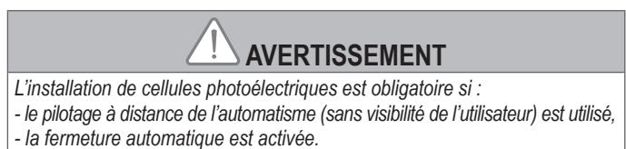
Si suppression des cellules, il est impératif de faire le pont entre les bornes 18 et 19.
