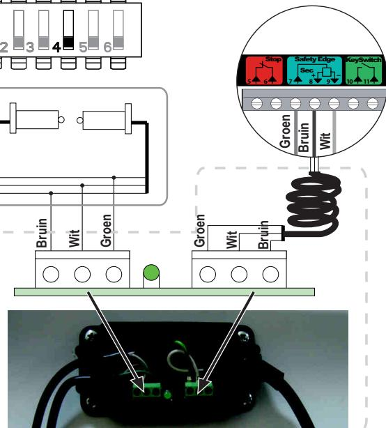
Als een draadloze contactstrip wordt vervangen door een bedrade contactstrip, moet de contactstripzender worden gewist (zie deel 12) zodat de bedrade contactstrip gebruikt kan worden.
