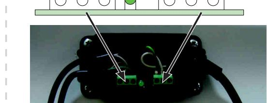
Se una costa di sicurezza filare sostituisce una costa di sicurezza radio, il trasmettitore costa di sicurezza radio deve essere cancellato (vedere sez. 12) per fare in modo che la costa di sicurezza filare venga presa in considerazione.
