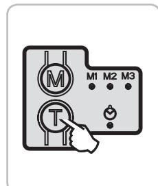
Kurzer Druck auf die Taste T, um eine der automatischen Schließfunktionen zu aktivieren.
