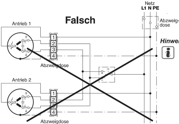
**Hinweis:** Die Antriebe dürfen nur parallel angeschlossen werden, wenn für jeden Antrieb und jede Laufrichtung ein separater Kontakt existiert.
