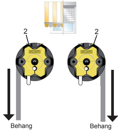
Die untere Endlage wird überfahren (der Antrieb schaltet zu spät ab):
