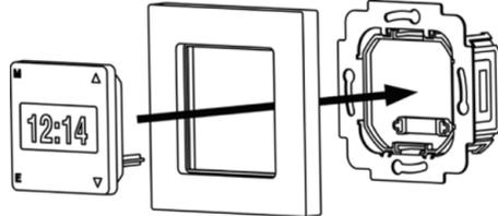
Das Netzteil an die Stromversorgung anschließen und in der UP-Dose befestigen. Das Display-Oberteil mit Rahmen aufstecken. Aufgrund der Außenabmessungen von 50 x 50 mm passt der Selvetimer Plus auch in viele Schalterprogramme führender Hersteller. Meist muss ein entsprechender Zwischenrahmen verwendet werden.
