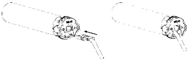
Avant de démonter le câble, veuillez le débrancher pour le mettre hors tension. Déverrouiller la prise par le trou latéral, dans la tête moteur. Vous pouvez utiliser un petit tournevis ou l'outil spécial SELVE. Veuillez simultanément pousser sur le clip de verrouillage avec le tournevis et tirer le câble hors du connecteur, pour l'extraire.
