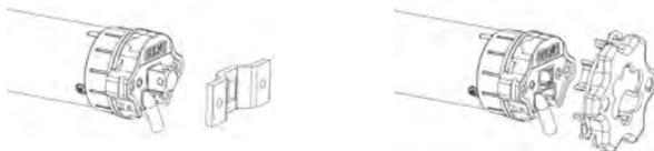
Des flasques ou plaques de montage peuvent être pré-montées ou vissées sur la tête du moteur. Pour la mise en oeuvre du carré de 12 mm, il faut installer une plaque en acier derrière la bride, pour garantir son positionnement axial.
