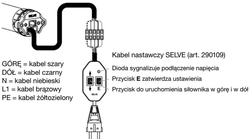
**Uwaga:** Przewód L1 (= brązowy) zawsze podłączać do napięcia ciągłego 230V, nawet jeśli napęd jest połączony z wyłącznikiem lub przełącznikiem nastawczym tylko do celów regulacji.
