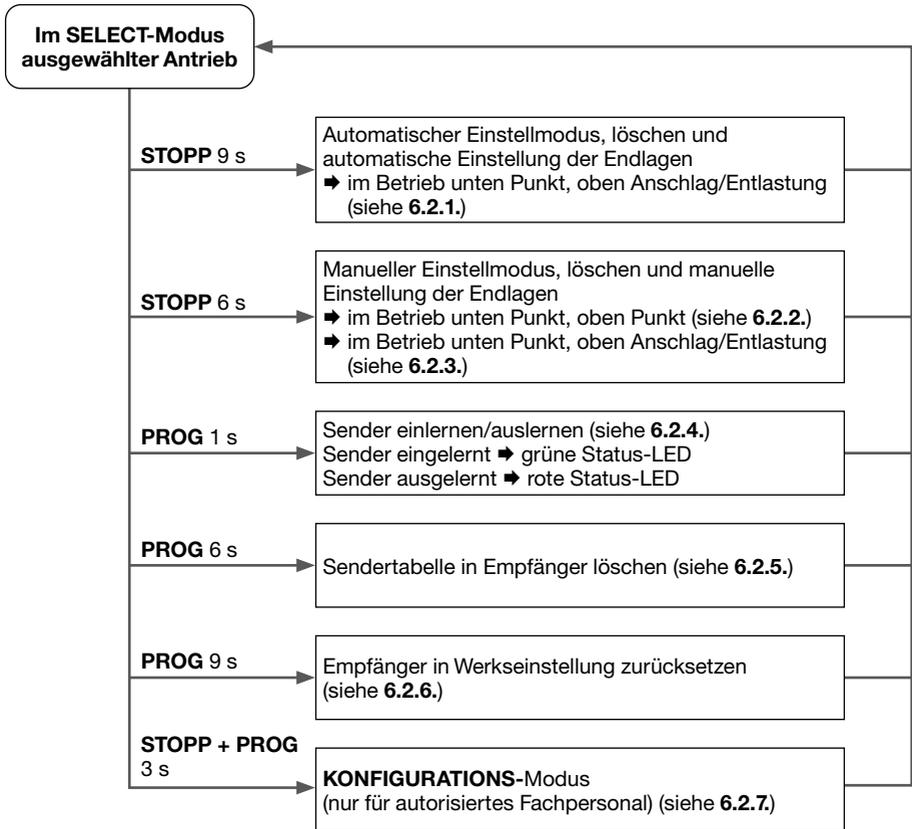
**Hinweis für Einstellungen unter Punkt 6.2.:** Der Antrieb muss für diese Einstellungen mit einem Sender im **SELECT-Modus** (Status-LED blinkt langsam orange) ausgewählt sein. Nach der Einstellung ist der Antrieb weiterhin ausgewählt (siehe Punkt 6.).
