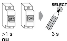
1. Coupez l'alimentation du récepteur > 1 sec. Les émetteurs seront sélectionnés dans les prochaines 4 minutes.
