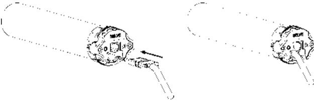
Schakel de aansluitkabel spanningsvrij alvorens deze te demonteren. Ontgrendel de vastgeklitte stecker via de zijdelingse opening aan de motorkop. Dit is mogelijk met behulp van de meegeleverde tool of gewoon met een schroevendraaier. Druk de grendelclip in en trek daarbij voorzichtig aan de kabel totdat de stecker los komt.
