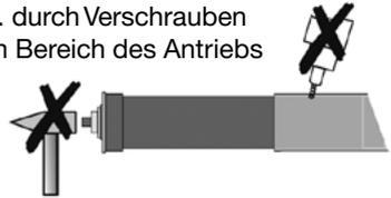
4. Die Welle mit dem Antrieb und der Wellenkapsel in den Lagern befestigen. Die Motorleitung und die Antenne nicht knicken und so verlegen, dass keine Schäden an Leitung oder Antenne entstehen können. Die Antenne nicht parallel zur Motorleitung legen. Die Antenne darf nicht gekürzt oder verlängert werden. Um zu verhindern, dass Wasser in den Antrieb läuft, die Motorleitung in einem Bogen nach unten verlegen, damit Fließwasser abtropfen kann.
