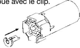
2. Introduire le moteur tubulaire dans le tube. Ne frappez en aucun cas sur le moteur, pendant cette opération. Il ne doit pas y avoir de jeu entre roue + couronne et le tube.
