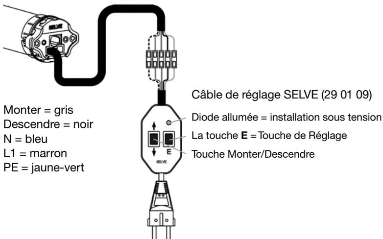
**Attention :** L1 (= marron) doit toujours être sous tension 230V, même quand le moteur pendant le réglage, est branché avec un interrupteur ou un câble de réglage.
