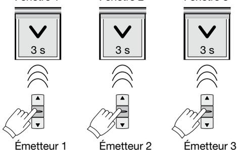
Dans un intervalle de 2 min., chaque moteur effectuera un déplacement Aléatoire de 3 sec. Appuyer sur **STOP** avec l'émetteur apparié.
