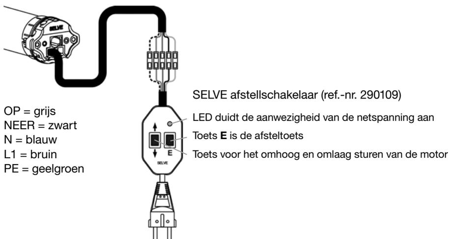
**Attentie:** L1 (= bruin) altijd op permanente spanning van 230V aansluiten, ook als de aandrijving alleen voor afsteldoeleinden is verbonden met een schakelaar of afstelschakelaar.
