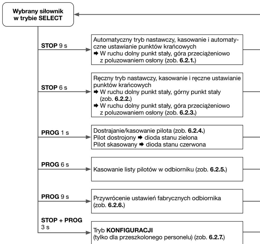
**Wskazówka do ustawień z punktu 6.2:** Aby wykonać te ustawienia wybrać odbiornik za pomocą nadajnika w trybie **SELECT** (dioda LED miga powoli na pomarańczowo). Po wykonaniu ustawień napęd jest nadal połączony z nadajnikiem (zobacz punkt 6).
