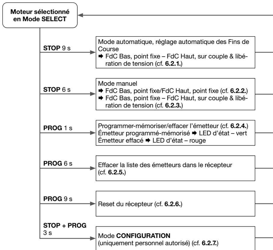
**Conseils pour le réglage §. 6.2. :** sélectionner le moteur avec un émetteur par le Mode **SELECT** (LED d'état clignote orange, lentement). Après le réglage, le moteur reste sélectionné (voire §.6).
