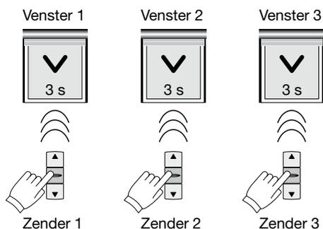
Binnen 2 minuten loopt iedere aandrijving toevallig kort gedurende 3 seconden. In deze tijd moet de aandrijving met de bijbehorende zender worden gestopt.
