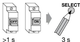
1. Odłączyć zasilanie odbiornika > 1 sekundy. Odbiorniki można znaleźć w ciągu następnych 4 minut.
