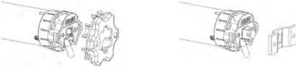
Außerdem können verschiedene Flansche oder Montageplatten vorgeschraubt werden. Bei Ablagerung mit Vierkant muss hinter dem Motorlager ein mechanischer Anschlag vorhanden sein, um ein axiales Verschieben des Vierkants zu verhindern.
