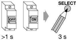
1. Die Netzspannung der Empfänger für >1 Sekunde unterbrechen. Die Empfänger können innerhalb der nächsten 4 Minuten gefunden werden.
