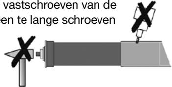
4. Plaats de wikkelbuis met zijn asprop en motor in de lagering en motorsteun. Knik motorkabel en antenne niet en verleg ze zodanig dat geen beschadigingen kunnen ontstaan. Leg de antenne liefst niet parallel aan de motorkabel. De antenne mag niet worden ingekort of verlengd. Verleg hem met een kleine lus naar beneden zodanig er geen water in de motor kan druipen.
