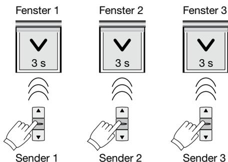
Innerhalb von 2 Minuten fährt jeder Antrieb zufällig kurz für 3 Sekunden. In dieser Zeit muss der Antrieb mit dem zugehörigen Sender gestoppt werden.
