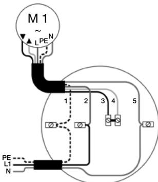
Siłownik radiowy z wyłącznikiem
