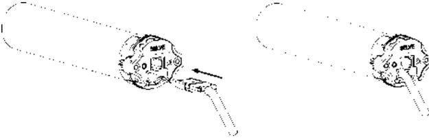
Przed wyjęciem wtyczki z gniazda w siłowniku odłączyć kabel spod napięcia. Zwolnić zatrząsk wtyczki przez boczny otwór w głowicy. Można wykonać to, albo przy pomocy śrubokręta, albo specjalnego narzędzia. Naciskając na zaczep zatrząsku, ciągnąć ostrożnie za kabel, aż wtyczka wyjdzie z zatrząsku i będzie można wyjąć kabel.
