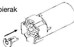
2. Wsunąć siłownik do wałka. Nie wolno uderzać przy tym w siłownik. Adapter i zabierak powinny dokładnie, bez żadnego luzu, przylegać do ścian wałka.
