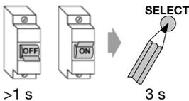
1. De voedingsspanning van de motor (ontvanger) voor langer dan 1 sec. onderbreken. De ontvangers kunnen binnen de volgende 4 minuten worden gevonden.
