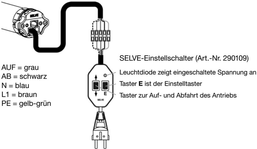
**Achtung:** L1 (= braun) immer an Dauerspannung 230 V anschließen, auch wenn der Antrieb nur zu Einstellzwecken mit einem Schalter oder Einstellschalter verbunden ist.
