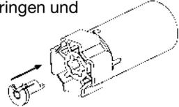
2. Den Antrieb formschlüssig in die Welle einschieben. Der Antrieb darf hierbei keine Schläge bekommen. Laufring- und Kupplungsadapter dürfen in der Welle kein Spiel haben.
