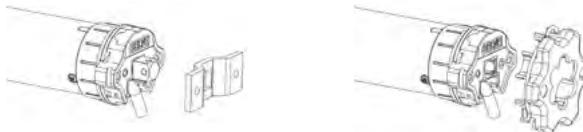
Des flasques ou plaques de montage peuvent être pré-montées ou vissées sur la tête du moteur. Pour la mise en oeuvre du carré de 12 mm, il faut installer une plaque en acier derrière la bride, pour garantir son positionnement axial.
