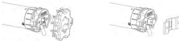
Oprócz tego można przykręcać różne kołnierze i płyty montażowe. Przy użyciu trzpienia, mocowanie musi być wyposażone w mechaniczny ogranicznik, zapobiegający przesunięciu trzpienia wzdłuż osi.
