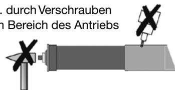
4. Die Welle mit dem Antrieb und der Wellenkapsel in den Lagern befestigen. Die Motorleitung nicht knicken und so verlegen, dass keine Schäden an der Leitung entstehen können. Um zu verhindern, dass Wasser in den Antrieb läuft, die Motorleitung in einem Bogen nach unten verlegen, damit Fließwasser abtropfen kann.
