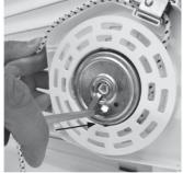
An der Schnur ziehen, damit die Arretierlasche frei wird. Anschließend die Lasche tief genug eindrücken. Lasche darf nicht am Haltearm schleifen (Funktionsbeeinträchtigung).
