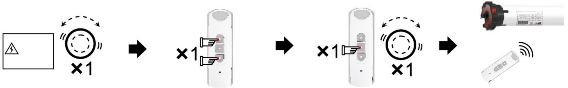
Betriebsspannung einschalten, der Antrieb wird vibrieren
