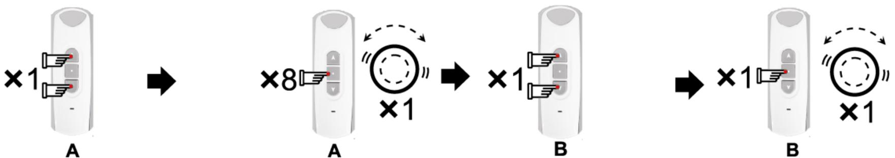
Auf dem Sender (A), welcher schon mit dem Motor verbunden ist, gleichzeitig Auf- und Ab-Taste drücken
