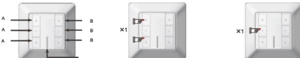
Kanal A und Kanal B steuern jeweils zwei Empfänger störungsfrei.
