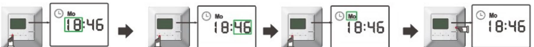
K1-Taste drücken, um in das Uhrzeitmenü zu gelangen. Es wird Uhrsymbol und Stundenanzeige auf dem Display angezeigt. Stunden über die Auf- / Ab-Taste einstellen.
